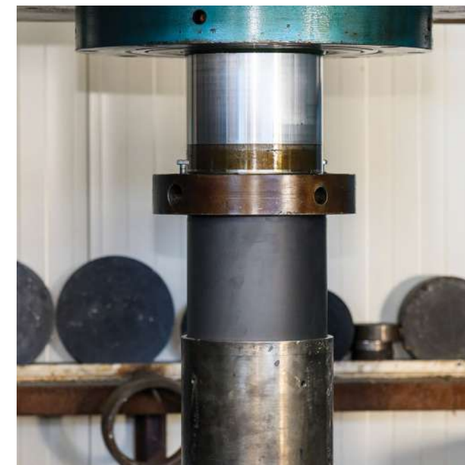
Slika 12. Uprešavanje novog ležaja/ Inserting a new bearing
