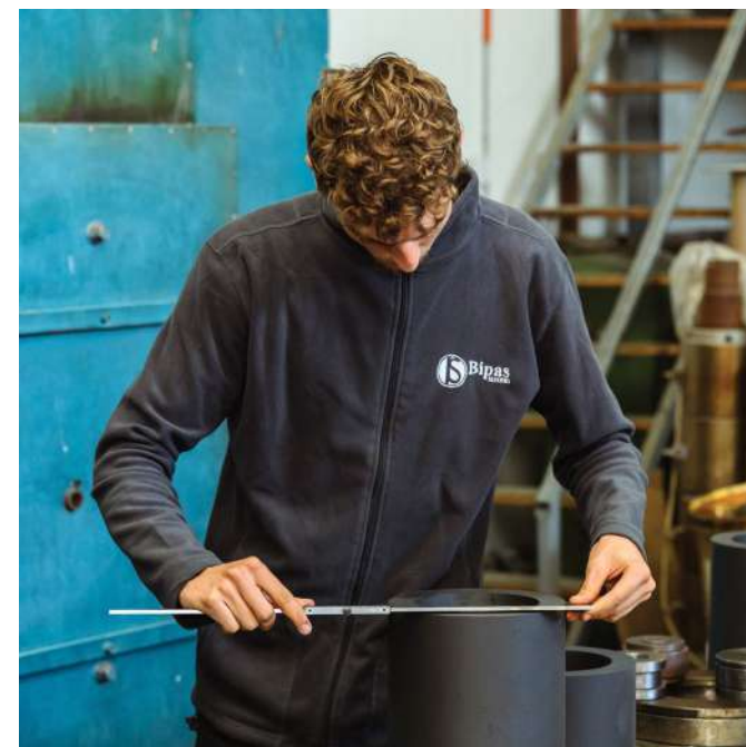
Slika 10. Provjera vanjskog promjera ležaja/ Checking the outside diameter of the bearing
