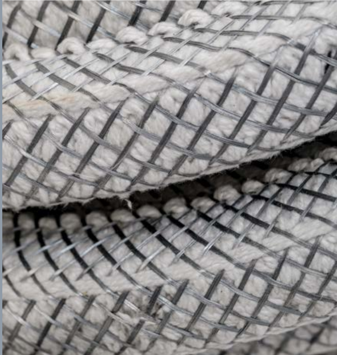
Slika 20. Keramička pletenica ojačana sa Inconel mrežom/ Ceramic braid reinforced with Inconel mesh
