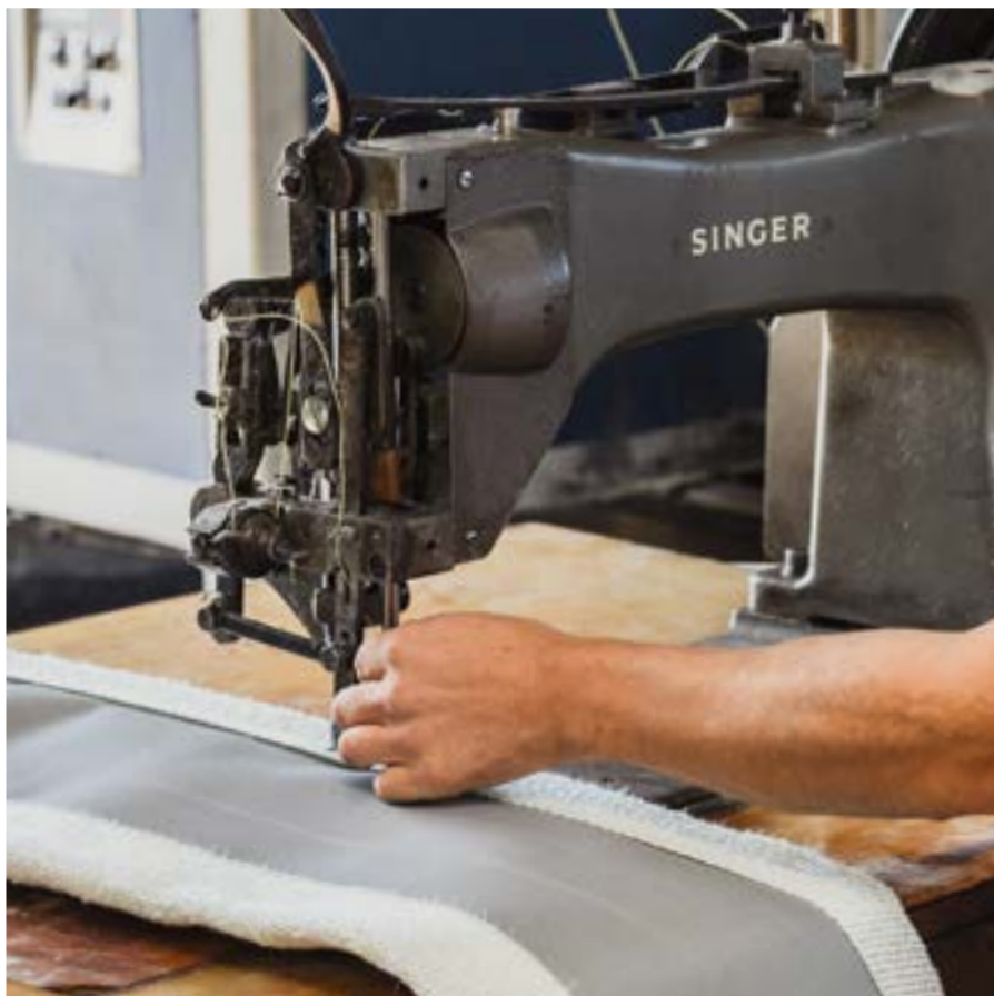
Slika 29. Šivanje trake kompenzatora/ Sewing the expansion joint tape
