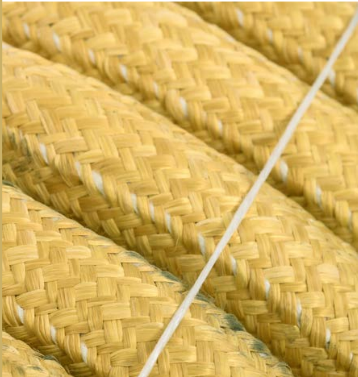
Slika 50. Pletenica od aramidnih vlakana/ Rope made of aramid fibers
